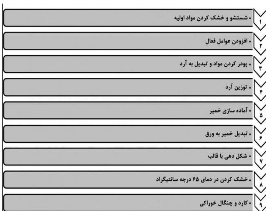
شکل ۴-۷. فلودیاگرام تهیه کارد و چنگال خوراکی با استفاده از Moringa oleifera
